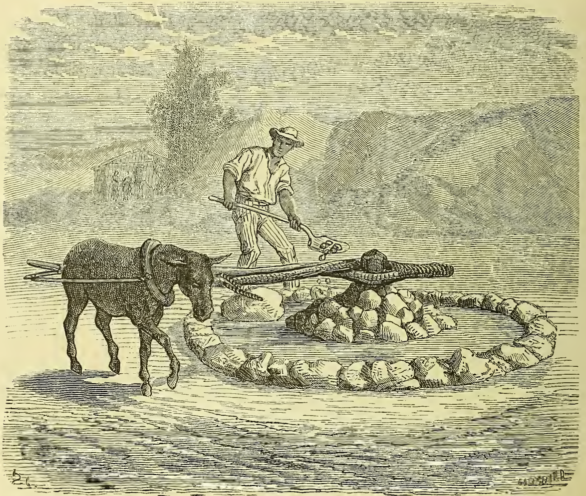
Fig. 149. — Arastra ou moulin mexicain pour le traitement des minerais d'or et d'argent.
